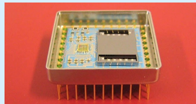
Das Butterfly Mikrogyroskop.
