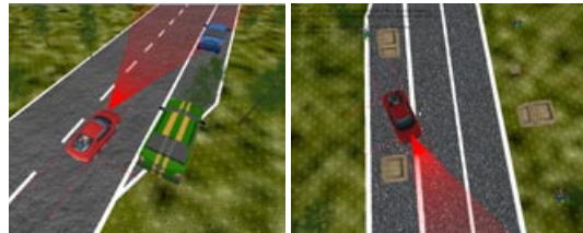
Abbildung E.01: Prinzipdarstellung der zusätzlichen Sensoren des Prototyps
