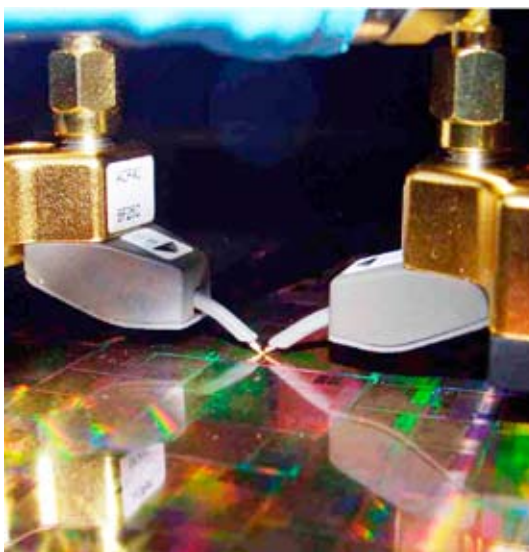
Abbildung 1.11: Aufbau zur experimentellen Charakterisierung des Einschaltverhaltens von Schutzelementen gegen schnelle Transienten auf Scheibenebene.
