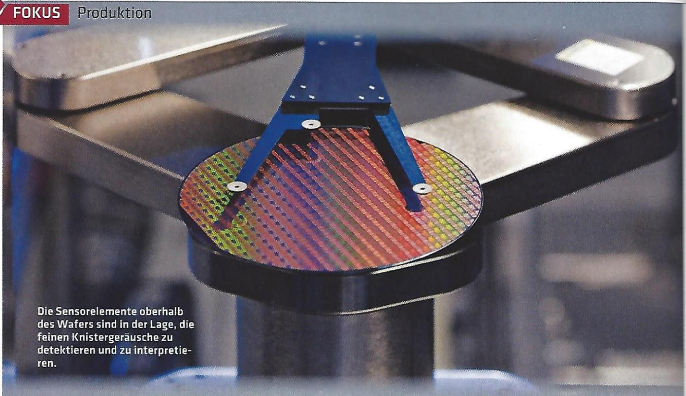
Die Sensorelemente oberhalb des Wafers sind in der Lage, die feinen Knistergeräusche zu detektieren und zu interpretieren.
