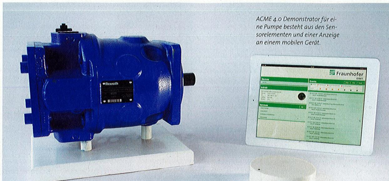
ACME 4.0 Demonstrator für eine Pumpe besteht aus den Sensorelementen und einer Anzeige an einem mobilen Gerät.
